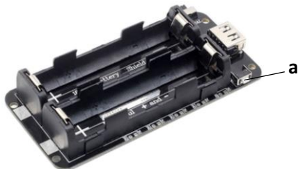
Slika ležišta za baterije
